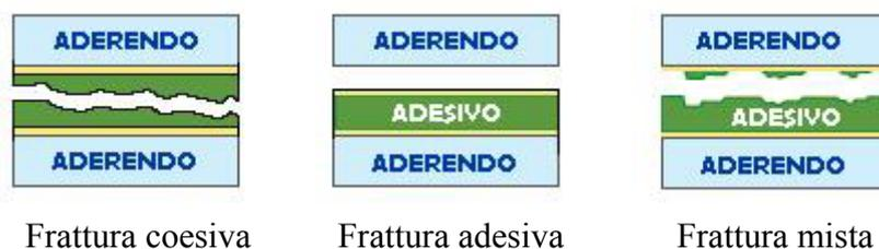
**Figura 2-10** – Confronto tra le diverse tipologie di frattura.
